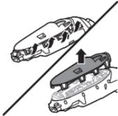
**4** Biegen Sie die Haken beiseite, und entfernen Sie die transparente Abdeckung der Akkueinheit.
