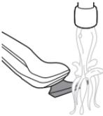
**Tipp:** Um eine optimale Leistung zu gewährleisten, ölen Sie die Zinken des Aufsatzes alle sechs Monate mit einem Tropfen Nähmaschinenöl.
