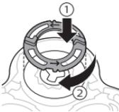
Richten Sie die Pfeilmarkierungen auf dem Ring an den Verlängerungen im Scherkopfhalter aus. Drehen Sie den Ring im Uhrzeigersinn, bis ein Klicken zu hören ist, das anzeigt, dass der Ring festsetzt.
