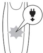
Das Gerät verfügt über eine Erinnerung "Vor Gebrauch von der Stromversorgung trennen". Das Symbol "Vor Gebrauch von der Stromversorgung trennen" blinkt und erinnert Sie, dass Sie das Gerät vom Netzteil trennen müssen, bevor Sie es einschalten können.
