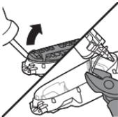
**5** Heben Sie das Akkufach heraus, und schneiden Sie die Drähte mit einer Drahtschere oder einer Schere ab.
