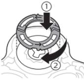
Jeder Haltering verfügt über zwei Aussparungen, die exakt in die Vorsprünge des Scherkopfhalters passen. Drehen Sie den Ring im Uhrzeigersinn, bis er hörbar einrastet und fest sitzt.
