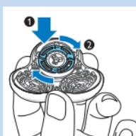
Bemærk: Hold skærholderen i hånden, når du sætter skærhovederne i igen, og sæt samleringene på igen. Placer ikke skærholderen på et underlag, når du gør dette, da det kan beskadige den.
