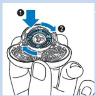
*Obs! Håll rakhuvudshållaren i handen när du sätter tillbaka rakhuvudena och sätt tillbaka låsringarna. Placera inte rakhuvudshållaren på en yta när du gör det eftersom det kan orsaka skada.*
