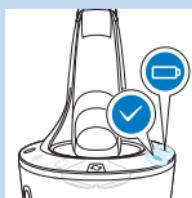
Bemærk: Hvis du trykker på SmartClean-systemets tænd/sluk-knap under renseprogrammet, afbrydes og nulstilles programmet. I så fald vil skyldes- eller tørresymbolet holde op med at blinke.
