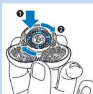
*Huomautus:Pidä ajopäään pidikettä käessäsi, kun asetat ajopääät ja kiinnitysrenkaat takaisin paikoilleen. Älä aseta ajopäään pidikettä alustalle, sillä se voi aiheuttaa vaurioita.*
