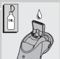
**۲** هر شش ماه یکبار، دندانه خط زن را با یک قطره روغن چرخ خیاطی روغن کاری کنید.
