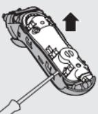
**6** Z izvijačem odstranite hrbtno ploščo napajalne enote.
