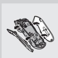
**3** Odkręć śruby w tylnej części golarki i zdejmij tylną ściankę obudowy.
