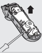
**6** Отворете задния панел на капсулованияия силов блок с отвертка.
