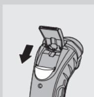
**1** Otevřete zastřihovač zatlačením pojistky směrem dolů.
