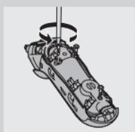
**3** Odvijte dva vijka na zadnjoj strani aparata za brijanje i odvojite zadnju ploču kućišta.
