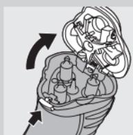
**1** Вимкніть бритву, вийміть вилку-адаптер з розетки електромережі та вилку пристрою з бритви.
