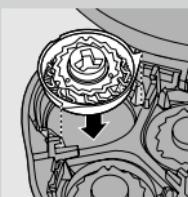
**4** Wyjmij głowice golące i włóż nowe do elementu golącego. Następnie załącz element zabezpieczający na swoje miejsce i dokręć blokadę w prawo.
