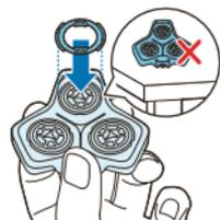
Nota: segure o suporte da cabeça de corte na sua mão quando voltar a inserir as cabeças de corte e voltar a fixar os anéis de retenção. Não pouse o suporte da cabeça de corte sobre nenhuma superfície, pois pode causar danos nas cabeças de corte.
