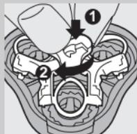
**5** Установите фиксирующую рамку в бритвенный блок, нажмите на колесико (1) и поверните его по часовой стрелке (2).
