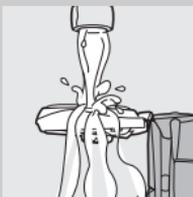
**4** Vyláchněte vnější část holicí jednotky.
