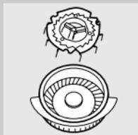
hlavice dřívě, než vyjmete další holicí hlavu. Pokud byste do některé korunky vložili jiný nožový věnec, trvalo by týdný než by se nožový věnec v jiné korunce zaběhl a v té době by výsledek holení nebyl uspokojivý.
