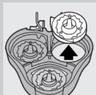
**4** Выньте бритвенные головки и вставьте новые бритвенные головки в бритвенный блок.
