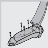
**1** Motorek ponechte v chodu, dokud se sám nezastaví, pak povolte příslušné šroubky a přístroj otevřte.
