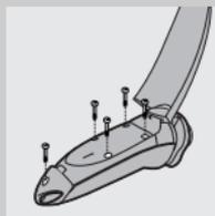
**1** Оставьте электробритву во включенном состоянии до остановки электродвигателя, отверните винты и откройте электробритву.
