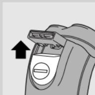
**1** Przesuń suwak w góre, aby otworzyć trymer. Trymer można otworzyć, gdy urządzenie jest włączone.
