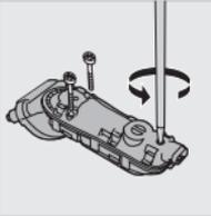
**7** Отвийте трите винта в задвижващия блок.
