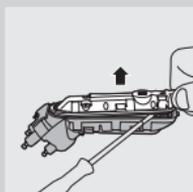
**8** Wyjmij moduł zasilający za pomocą śrubokrętu.
