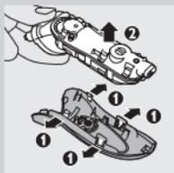
**6** Odegnij na boki 4 haczyki i wyjmij moduł zasilający.
