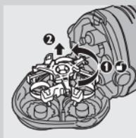
**3** Okrenite kvačicu za zaključavanje u smjeru obrnutom od smjera kazaljke na satu (1) i izvadite okvir za pričvršćivanje (2).
