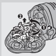
**3** Odkręć blokadę w lewo (1) i wyjmij element zabezpieczający (2).
