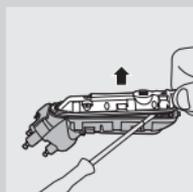
**8** Pomocí šroubováku odstraňte kryt napájecí jednotky.
