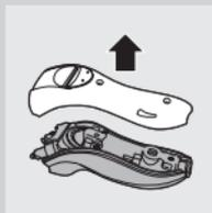
**4** Снимите заднюю панель.
