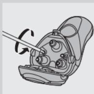
**3** Отвинтите два винта в отсеке для волос.
