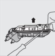
**8** Отворете капака на силовия блок с помощта на отвертка.
