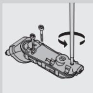
**7** Csavarja ki a motoregység három csavarját.
