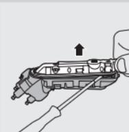
**8** Z izvijačem odstranite pokrov motorne enote.
