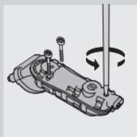
**7** Odkręć trzy śruby modułu zasilającego.
