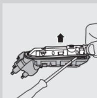
**8** Îndepărtați capacul compartimentului motor cu o șurubelniță.
