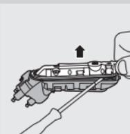
**8** С помощью отвертки снимите крышку блока питания.
