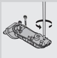
**7** Demontați șuruburile din compartimentul motorului.
