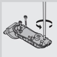
**7** Povolte tři šrouby v napájecí jednotce.
