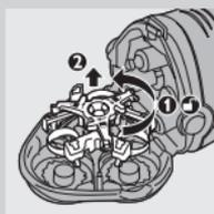
**3** Zavrtite zaklep proti levi (1) in odstranite nosilno ogrodje (2).
