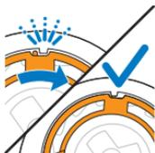
Chaque anneau de fixation est pourvu de deux encoches qui s'encastrent dans les parties saillantes du support de la tête de rasage. Faites tourner l'anneau dans le sens des aiguilles d'une montre jusqu'à ce que vous entendiez un clic qui indique que l'anneau est fixé.
