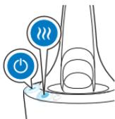
Après la phase de rinçage, la phase de séchage démarre automatiquement. Pendant cette phase, le symbole de séchage clignote. Lorsque la phase de séchage est terminée (après environ 4 heures), le symbole du séchage s'allume en continu.
