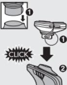
**2 將新電鬍刀組的突耳插入電鬍刀頂端的凹槽 (1)，再將電鬍刀組往下壓 (2) 即可安裝到電鬍刀上 (會聽見「喀噠」一聲)。**
