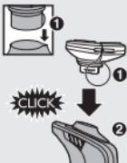
**2** 将新剃须刀头部件的凸缘插入剃须刀顶部的槽内 (1)。然后向下按剃须刀头部件 (2) 以将其安装在剃须刀上 (听到咔哒一声)。
