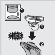
**2** Inserite la linguetta della nuova unità di rasatura nella fessura posta nella parte superiore del rasoio (1). A questo punto, premete l'unità di rasatura verso il basso (2) finché il rasoio non scatta in posizione.
