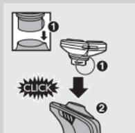
**2** Introduza a saliência da nova unidade de corte na ranhura na parte superior da máquina de barbear (1). Pressione a unidade de corte para baixo (2) para a encaixar na máquina de barbear ('clique').
