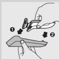
**4** Inserite per prima la parte superiore del rasoio nell'astuccio di ricarica (1), quindi premete la parte inferiore del rasoio (2).
