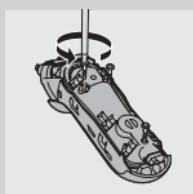
**5** Povolte tři šrouby na vodotěsné napájecí jednotce.
