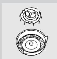
**2** S priloženo ščetko očistite rezila in ležišča. Hkrati čistite le eno rezilo in pripadajoče ležišče, saj spadata skupaj. Če po pomoti med seboj zamenjate rezila in ležišča brivnih glav, lahko traja več tednov, preden se znova vzpostavi optimalno britje.
