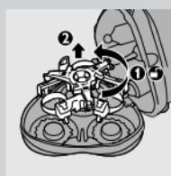
**1** Odprite brivno enoto, zavrtite zaklep proti levi (1) in odstranite nosilno ogrodje (2).
