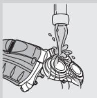
**3** Jedinicu za brijanje i spremište za dlake čistite držeći ih pod mlazom vruće vode.
