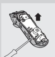
**6** Usuń tylną ściankę modułu zasilającego za pomocą śrubokrętu.
