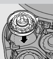
**4** Izvadite glave za brijanje i stavite nove u jedinicu za brijanje. Vratite granični okvir u jedinicu za brijanje i okrenite bravu u pravcu kazaljke na satu.
