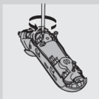
**5** Odvrnite tri vijka na jedinici za napajanje.
