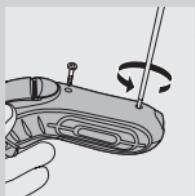
**2** Ostavite aparat da radi dok se ne zaustavi, odvrnite dva vijka spremišta za dlačice i izvadite ga.
