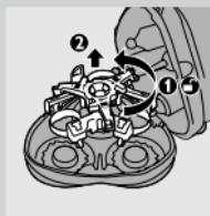
**1** Otevřete holící jednotku, otočte pojistku směrem doleva (1) a vyjměte přídržný rámeček (2).
