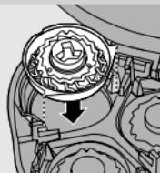
**4** Izvadite stare glave za brijanje iz jedinice za brijanje i stavite nove. Vratite okvir za pričvršćivanje u jedinicu za brijanje i okrenite kvačicu za zaključavanje u smjeru kazaljke na satu.
