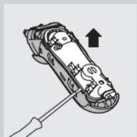
**6** Odvojite stražnju ploču jedinice za napajanje pomoću odvijača.
