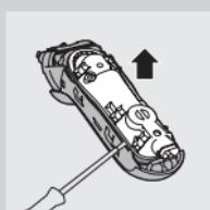
**6** Šroubovákem sejměte zadní kryt vodotěsné napájecí jednotky.
