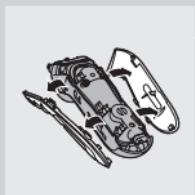
**4** Odvojite bočne ploče povlačeći ih s jedinice za napajanje.
