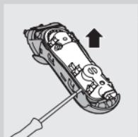
**6** Csavarhúzó segítségével vegye le a tömített motoregység hátsó elemét.
