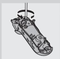
**5** Csavarja ki a tömített motoregység három csavarját.
