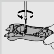
**6** 用螺丝刀将电源部件盖取下。
