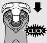
**1** Pasangkan kembali penutup perlindungan pada alat pencukur untuk mengelakkan kerosakan.
