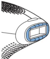
Opmerking: De veiligheidsring heeft contactschakelaars die samen het veiligheidssysteem van het apparaat vormen. Deze veiligheidsring voorkomt dat het apparaat onopzettelijk flitst terwijl er geen contact met de huid is.
