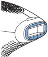
Hinweis: Der Sicherheitsring verfügt über Kontaktsschalter, die gemeinsam das Sicherheitssystem des Geräts bilden. Dieser Sicherheitsring verhindert unbeabsichtigte Lichtblitze, wenn kein Hautkontakt besteht.
