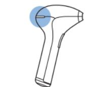
Remarque : l'anneau de sécurité est équipé d'interrupteurs de contact servant de système de sécurité de l'appareil. Il évite tout flash indésirable lorsque l'appareil ne touche pas la peau.
