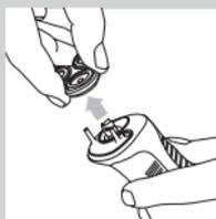
Tauschen Sie die Schereinheit jährlich aus, um auch weiterhin optimale Rasiererergebnisse zu erzielen. Ersetzen Sie die Schereinheit ausschließlich durch eine HS85 Philips Schereinheit.
