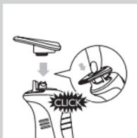
**2** Ziehen Sie den Langhaarschneider aus der Aussparung an der Nachfüll- und Ladestation und setzen Sie ihn auf den Rasierer. Er rastet mit einem Klicken ein.
