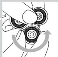
ممکن است سربهای اصلاح را در نگهدارنده اصلی قرار نداده باشید. یکی از سربهای اصلاح دارای سوراخ حالت دهنده نمی باشد و باید در نگهدارنده خاصی قرار داده شود. مطمئن شوید که سری اصلاحی که سوراخ حالت دهنده ندارد را در نگهدارنده صحیح قرار دهید. هنگامی که واحد اصلاح روی ریش تراش سوار شده باشد، این نگهدارنده، نزدیکترین نگهدارنده به دکمه روشن/خاموش است.
