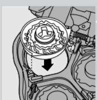
**3** 將電鬍刀刀頭裝回電鬍刀組。將固定架裝回電鬍刀組上，並以順時針方向轉動鎖扣。
