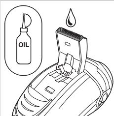
เคล็ดลับ: ทุกๆ หกเดือน ควรหยดน้ำมันจักรเที่อหลอสิ่นเข้าพินของหัวกันขอ เพื่อให้กันขอได้อ่ายมีประสิทธิภาพ
