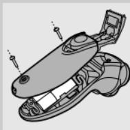
**2** Deje funcionar la afeitadora hasta que se pare, abra el cortapatillas, desenrosque los tornillos y abra la afeitadora.
