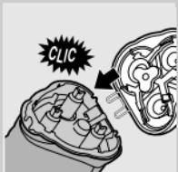
correctement attaché, c.-à-d. s'il n'a pas du jeu ou s'il n'est pas endommagé. Si le ressort est correctement attaché, l'unité de rasage peut être facilement remontée. Cependant, si le ressort est détaché ou déterioré, veuillez consulter votre revendeur ou un Centre Service Agréé Philips pour ne pas endommager le rasoir.
