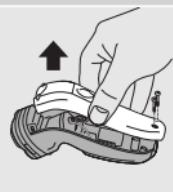
بگذارید که دستگاه تا هنگام متوقف شدن کار کند، پیچها را شل کنید و ریش تراش را باز کنید.
