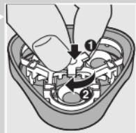
أعد تركيب وحدة الحلاقة مرة أخرى في ماكينة الحلاقة. لتنظيف إضافي شامل، قم بتنظيف رؤوس الحلاقة عن طريق وضعها كل ستة أشهر في سائل مزيل للشحوم (مثل الكحول). لفك رؤوس الحلاقة. اتبع الخطوات من (١) إلى (٤) الموضحة أعلاه . بعد التنظيف، قم بتزييت النقطة الوسطى بداخل الواقيات باستخدام نقطة من زيت مكينة الخياطة لمنع تأكل رؤوس الحلاقة.
