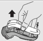
Nach Entnahme des Akkus darf das Gerät nicht mehr am Netz betrieben werden.
