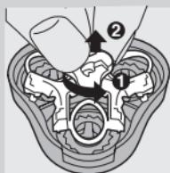
**3** Ruotate la rotella in senso antiorario (1) e togliete la struttura di supporto (2).
