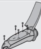
**1** Deje que la afeitadora funcione hasta que se pare. A continuación, afloje los tornillos y abra la afeitadora.
