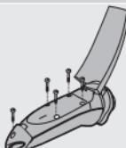
**1** Laissez l'appareil fonctionner jusqu'à l'arrêt complet du moteur, puis ôtez les vis et ouvrez l'appareil.
