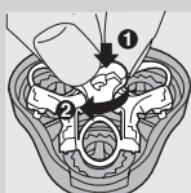
**5** Rimettete la struttura di supporto nell'unità di rasatura, premete la rotella (1) e ruotatela in senso orario (2).
