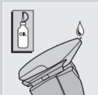
**2** Als u de tondeuse regelmatig gebruikt, smeer dan elke zes maanden de tanden van de tondeuse met een druppeltje naaimachineolie.
