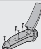
**1** Laat het scheerapparaat lopen tot het stopt, draai de schroeven los en maak het scheerapparaat open.
