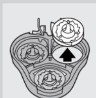
**3** Drehen Sie das Rädchen gegen den Uhrzeigersinn (1), und entnehmen Sie den Scherkopfhalter (2).
