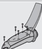
**1** Lassen Sie den Motor des Rasierers laufen, bis er stillsteht. Lösen Sie dann die Schrauben, und öffnen Sie den Rasierer.
