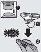
**2 Inserite la linguetta della nuova unità di rasatura nella fessura posta nella parte superiore del rasoio (1). A questo punto, premete l'unità di rasatura verso il basso (2) finché il rasoio non scatta in posizione.**
