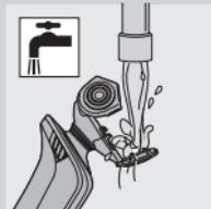
**3** Lave as três cabeças de corte e as três câmaras de recolha dos pêlos debaixo da torneira de água quente durante 30 segundos.
