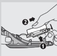
**8** Trek de draden uit de motorunit en verwijder de accu.
