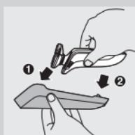
**3** Trek aan de bovenkant van de klep (1) en verwijder deze (2).
