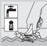
Nunca seque a unidade de corte com uma toalha ou tecido, pois pode danificar as cabeças de corte.
