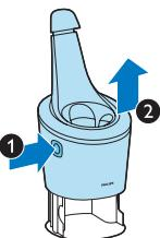
**1** Apăsați butonul de pe partea laterală a sistemului SmartClean (1) și ridicați partea superioară a sistemului SmartClean (2).
