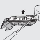
**7** Fjern bakpanelet på det forseglede drivverket med en skrutrekker.
