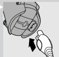
**٣** انزع مقبس الكهرباء من قابس الحائط واسحب مقبس الجهاز من الآلة عند اتمام شحن البطارية بالكامل.
