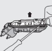
**7** Ta bort den inkapslade strömpanelens baksida med en skruvmejsel.
