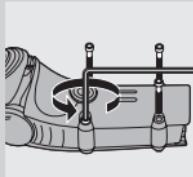
**3** Skruva ur de fyra skruvarna på rakapparatens framsida med en insexförspets och ta bort höljets framsida.
