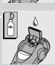
۳ هر شش ماه یکبار، دندانه خط زن را با یک قطره روغن چرخ
