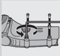
**2** La barbermaskinen gå til den stopper, løsne de to skruene i skjeggkammeret med en skrutrekker, og fjern skjeggkammeret.
