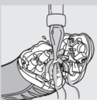
**3** Holiacu jednotku a komoru na chípky očistite opláchnutím pod prúdom horúcej vody.
