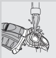
**3** Jedinicu za brijanje i spremište za dlake čistite držeći ih pod mlazom vruće vode.
