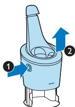
**2** Izvadite praznu patronu za čišćenje iz sistema SmartClean i prospite svu preostalu tečnost za čišćenje iz patronе за čišćenje. Možete jednostavno da prospete tečnost za čišćenje u lavabo.
