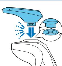
**2** Вставте виступ насадки-тримера у віймку на верхній частині бритви. Потім потисніть насадку-тример донизу, щоб зафіксувати її на пристрої.
