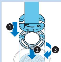
**6 Așezați suportul inelului de fixare pe inelul de fixare (1), așezați-l pe capul de bărbierire (2) și răsuciți-l în sens orar (3) pentru a reatașa inelul de fixare.**
