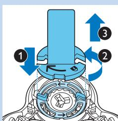
**2** Nosilec pritrdilnega obročka namestite na pritrdilni obroček (1), obrnite v levo (2) in dvignite z brivne glave (3).
