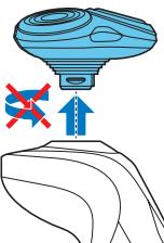
**3** Introduceți tortița accesoriului de aranjare a bărbii în fanta din partea superioară a aparatului. Apoi apăsați în jos accesoriul de aranjare a bărbii pentru a-l ataşa la aparat (se fixează cu un „clic”).
