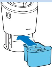
5 Čistilni vložek vstavite v sistem SmartClean.
