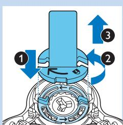
**2** Umieść uchwyt pierścienia zabezpieczającego na pierścieniu zabezpieczającym (1), obróć go w lewo (2) i zdejmij go z głowicy golącej (3).
