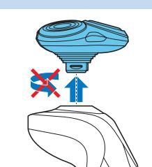
**3** Ievietojiet bārdas veidotāja izcilni spraugā skuvekļa augšgalā. Pēc tam nospiediet bārdas veidotāja uzgali lejup, lai piestiprinātu to pie ierīces (atskan klikšķis).
