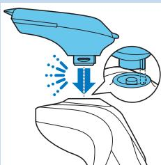
**3** Вставьте выступ на насадке-стайлере в паз в верхней части прибора. Затем надавите на насадку-стайлер, чтобы зафиксировать ее на приборе (должен прозвучать щелчок).
