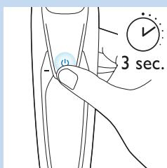
Під час подорожей бритву можна заблокувати. Блокування для транспортування запобігає випадковому вмиканню бритви.
