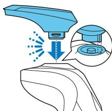
**2** Ievietojiet trimmera uzgaļa izcilni atverē skuvekļa augšgalā. Pēc tam nospiediet trimmeri lejup, lai piestiprinātu to pie ierīces (atskan klikšķis).
