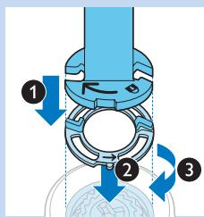
**6** Поместите держатель фиксирующего кольца в фиксирующее кольцо (1), затем поместите его на бритвенную головку (2) и поверните по часовой стрелке (3), чтобы установить фиксирующее кольцо на место.
