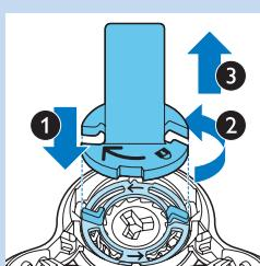
**2** Držać prstena za pričvršćivanje postavite na prsten za pričvršćivanje (1), okrenite ga ulijevo (2) i podignite ga s glave za brijanje (3). Izvadite prsten za pričvršćivanje iz držaća prstena za pričvršćivanje i ponovite postupak za ostale prstene za pričvršćivanje.
