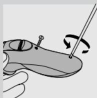
**2** После того, как энергия аккумуляторов электробритвы будет выработана, и прибор полностью остановится, отвинтите два винта на задней стороне бритвы.
