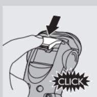
**2** Sulje trimmeri siten, että se napsahtaa kiinni.
