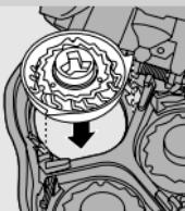
**3** Setzen Sie die Scherköpfe wieder in die Schereinheit ein. Setzen Sie dann den Scherkopfhalter wieder in die Schereinheit und drehen Sie die Verriegelung im Uhrzeigersinn fest.
