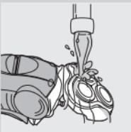
**3** Skyd skærhoved og skægkammer grundigt under den varme hane.
