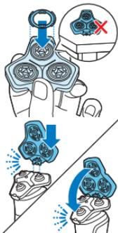
Remarque : Tenez le support de la tête de rasage dans la main lorsque vous réinsérez les têtes de rasage et remplacez les anneaux de fixation. Ne placez pas le support de la tête de rasage sur une surface lors de cette opération, car vous risqueriez de l'endommager.
