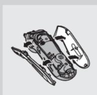
**2** Ostavite aparat za brijanje da radi dok se ne zaustavi, odvrnutezavrtnje na komori za prikupljanje dlaka i izvadite je.
