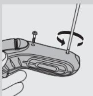
**3** Развийте двата винта отзад на самобръсначката и свалете задния капак на корпуса.
