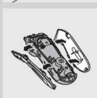
**3** Відкрутіть два гвинти позаду бритви і зніміть задню панель корпуса.
