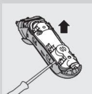
**6** Отворете задния панел на капсулования силов блок с отвертка.
