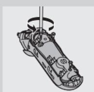
**3** Odvijte dva vijka na zadnjoj strani aparata za brijanje i odvojite zadnju ploču kućišta.
