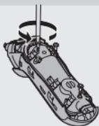
**5** Odkręć trzy śruby modułu zasilającego.
