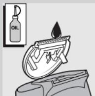
**3** Cada seis meses lubrique los dientes del cortapatillas con una gota de aceite de máquina de coser.
