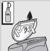
**3** Smeer elke zes maanden de tanden van de tondeuse met een druppeltje naaimachineolie.
