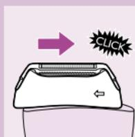
Der Scherkopf kann nur in einer bestimmten Richtung aufgesetzt werden.
