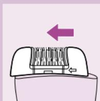
**4** Inserite la testina di rasatura sull'apparecchio, premendola nella direzione della freccia ("click").
