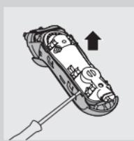
**6** 用螺丝刀将密封电源部件的后面板取下。
