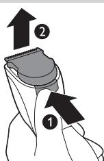
**2** Lắp gờ của bộ phận cắt mới vào rãnh dẫn(1) và ấn bộ phận cắt vào lại thiết bị (2).
