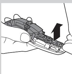
5 Lepaskan panel samping. Tarik bagian bawah papan sirkuit tercetak dengan baterai isi ulang yang terpasang dari alat.
