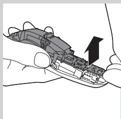
**5** ถอนแผงด้านข้างออก ตึงที่ด้านล่างของแผงวงจรที่มีแบตเตอรี่ที่ชาร์จใหม่ได้ออกจากตัวเครื่อง
