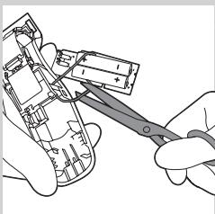
**6** Cắt các dây điện để tách pin sạc ra khỏi thiết bị.
