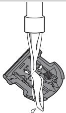
**5** Bersihkan unit pemotong dengan sikat atau bilas di bawah keran.
