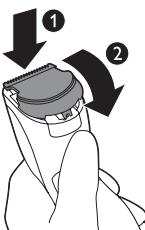
**8** 将修剪部件的凸缘插入导向槽 (1) 内，然后将修剪部件推回产品 (2)。
