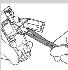
6 Potong kabel untuk memisahkan baterai isi-ulang dari alat.
