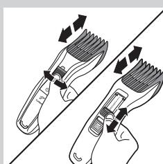
**2** 将长度设定调节器转到所需的长度设定。
