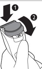
**2** 將新刀組的突耳插入導引槽 (1)，接著將刀組推回產品裝上 (2)。
