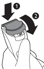
**8** 將刀組的突耳插入導引槽 (1)，接著將刀組推回產品裝上 (2)。
