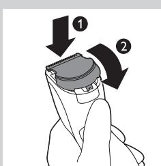
**2 ลิ้นห่วงของชุดใบมีดใหม่เข้าไปในร่องนำ (1) และดันชุดใบมีดกลับเข้าไปที่ตัวเครื่อง (2)**
