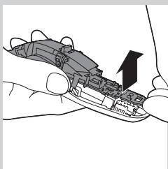
**5** 拆卸兩邊的護板。拉取印刷電路板的底部，連同其上充電式電池，一起從本產品取下。
