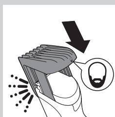
Setelan panjang rambut ditunjukkan dalam milimeter; sisir memangkas rambut sepanjang 1mm hingga 23mm. Setelan setara dengan panjang rambut yang tersisa setelah pemotongan.
