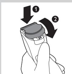
**8 ลิ้นห่วงของชุดใบมีดเข้าไปในร่องนำ (1) และดันชุดใบมีดกลับเข้าไปที่ตัวเครื่อง (2)**
