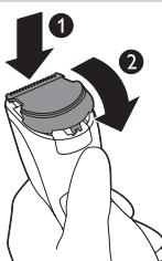
**8** Masukkan cuping unit pemotong ke dalam selot pemandu (1) dan dorong unit pemotong kembali ke dalam alat (2).
