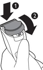
**8** Lắp gờ của bộ phận cắt vào rãnh dẫn (1) và ấn bộ phận cắt vào lại thiết bị (2).
