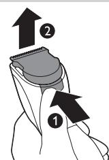
**2** 将新修剪部件的凸缘插入导向槽 (1) 内，然后将修剪部件推回产品 (2)。
