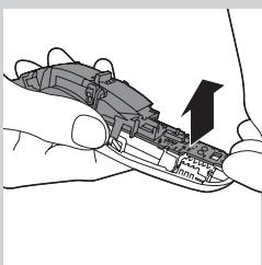
**5** Tháo mặt sau. Kéo phần dây của bảng mạch in có pin sạc đi kèm ra khỏi thiết bị.
