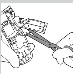
**6** 剪斷電線，將充電式電池與與產品分開。
