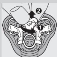
**3** 以逆時針方向轉動轉盤 (1)，將固定架拆下 (2)。
