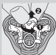
**3** 逆时针方向转动轮轴 (1) 并取下固定架 (2)。
