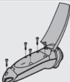
**1** 讓電鬍刀持續運轉直到完全停止為止，拆下螺絲並拆開電鬍刀本體。
