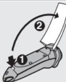
**3** Lắp tuýp kem cạo cùng với ống bơm vào máy. Nó chỉ nằm khít vào máy nếu đặt mặt màu trắng của ống bơm hướng lên.
