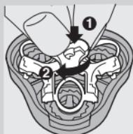
**5** Kembalikan rangka penahan ke dalam unit pencukur, tekan roda (1) dan putarkan ke arah jam (2).
