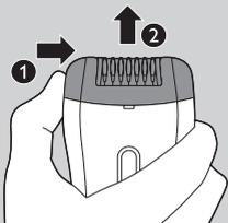
**3** Poussez la tête d'épilation vers la droite (1) et retirez-la de l'appareil (2).
