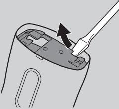
**3** Insérez le tournevis dans la fente du circuit imprimé (1). Faites tourner le tournevis jusqu'à ce que la connexion entre le circuit imprimé et la batterie se rompe (2).
