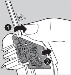
**4** Sortez la batterie rechargeable de l'appareil à l'aide du tournevis.
