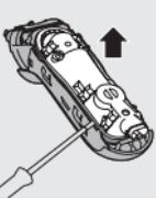
**6** С помощью отвертки снимите заднюю панель с герметичного блока питания.
