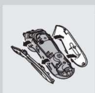
**2** Ostavite aparat za brijanje da radi dok se ne zaustavi, odvrnutezavrtnje na komori za prikupljanje dlaka i izvadite je.
