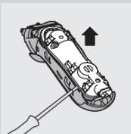
**6** Îndepărtați panoul posterior al unității de alimentare etanșe cu ajutorul unei șurubelnită.
