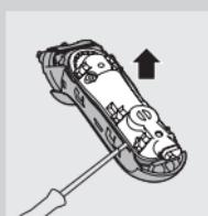
**6** Šroubovákem sejměte zadní kryt vodotěsné napájecí jednotky.
