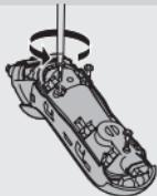
**5** Odkręć trzy śruby modułu zasilającego.
