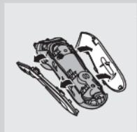
**3** Развийте двата винта отзад на самобръсначката и свалете задния капак на корпуса.
