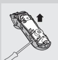
**6** Uklonite zadnju ploču zapečaćene jedinice za napajanje pomoću odvijača.
