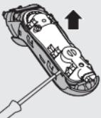
**6** Usuń tylną ściankę modułu zasilającego za pomocą śrubokrętu.
