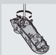
**4** Uklonite ploče sa obe strane aparata izvlačenjem iz zapečaćene jedinice za napajanje.
