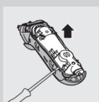
**5** Отвийте трите винта в капсулования силов блок.
