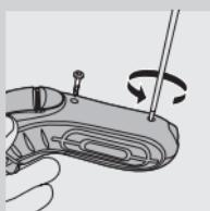
**2** Brivnik pustite delovati, dokler se sam ne zaustavi, odvijte vijaka v prostoru za dlačice in ga odstranite.
