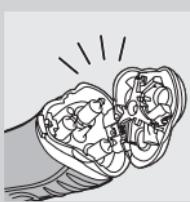
► Dokładnie wyczyść element golący od wewnątrz i od zewnątrz.
