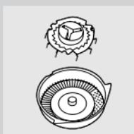
**1** Otwórz element golący, odkręć blokadę w lewo (1) i wyjmij element zabezpieczający (2).
