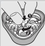
**5** 將固定架裝回電鬚刀組 (1)，並以順時針方向轉動刮鬚轉盤 (2)。
