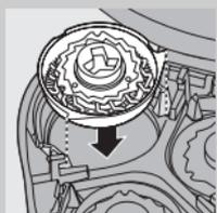
**3** Okrenite bravu u smeru suprotnom od kazaljke na satu (1) i izvadite granični okvir (2).
