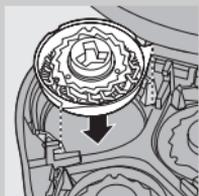
**3** Zavrtite zapiralo v nasprotni smeri urinega kazalca (1) in odstranite nosilno ogrodje (2).
