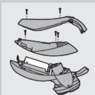
**2** Lăsați aparatul să funcționeze până ce se oprește, desfaceți șuruburile și deschideți-l.
