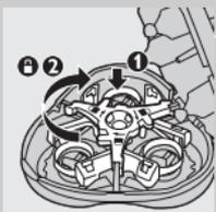
**5** Установите фиксирующую рамку в бритвенный блок (1) и поверните его по часовой стрелке (2).
