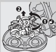
**1** Otvorte holiacu jednotku, zámkom otočte proti smeru pohybu hodinových ručičiek (1) a vyberte prítlačný rám (2).
