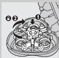
**5** Umístěte přídržný rámeček zpět do holicí jednotky (1) a otočte pojistku směrem doprava (2).
