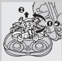
**1** Otvorite jedinicu za brijanje, okrenite bravu u smeru suprotnom od kazaljke na satu (1) i izvadite granični okvir (2).
