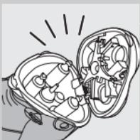
**6** Opet otvorite jedinicu za brijanje i ostavite je otvorenu da omogućite da se uređaj potpuno osuši.
