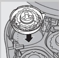
**3** Zámkom otočte proti smeru pohybu hodinových ručičiek (1) a vyberte prítlačný rám (2).
