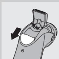
**1** Отворете машинката за подстригване чрез избутване на плъзгача надолу.
