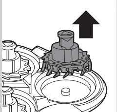
4 從電鬍刀刀網上取下刀片。
