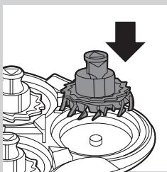
7 清潔後，請將刀片放回電鬍刀刀網，使刀片腳朝下。
