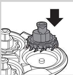
**7** Selepas membersihkannya, tempatkan pemotong kembali ke dalam pelindung pencukur dengan kaki pemotong menunjuk ke bawah.
