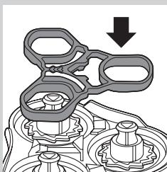
8 將固定架裝回電鬍刀刀頭固定座。
