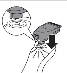
**3** 將鬚角造型修容器配件的突耳插入電鬍刀頂端的凹槽 (1)，再將鬚角造型修容器配件組往下壓 (2)，即可安裝到電鬍刀上 (會聽見「喀噠」一聲)。
