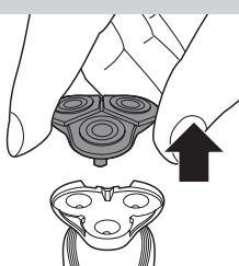
**3** 將電鬍刀刀頭固定座從電鬍刀組底部抽出，在熱水下沖洗 30 秒。
