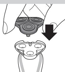
**5** 將電鬍刀刀頭固定座重新接上電鬍刀組的底部 (會聽見「喀噠」一聲)。
