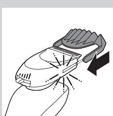
**1** 將梳具直接滑入鬚角造型修容器配件兩側的導引溝槽 (直到聽見「喀噠」一聲)。
