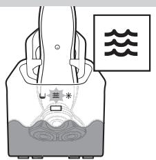
▶ 在清洗程序的第二个阶段，剃须刀处在干燥档位，这由一个闪烁的干燥符号表示。此阶段大约需要 2 小时。在此程序结束之前剃须刀一直都会处在此档位。
