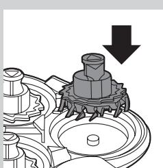
7 Sau khi làm sạch, đặt lưỡi cắt trở lại bộ phận bảo vệ với chân lưỡi cắt hướng xuống dưới.
