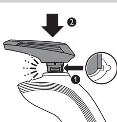
**2** 将修剪器的凸缘插入剃须刀顶部的槽内 (1)。然后按下修剪器 (2) 以将其安装在剃须刀上 (可听到“咔哒”一声)。
