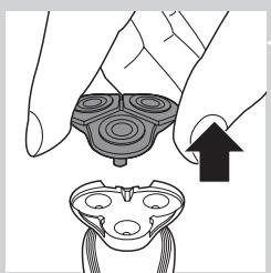
**2** 將電鬍刀刀頭固定座從電鬍刀組底部抽出。
