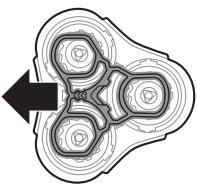
2 將綠色固定架朝固定架上指示的箭頭方向推出。
