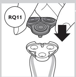
**3** 將新的電鬍刀刀頭固定座接上電鬍刀組的底部(會聽見「喀噠」一聲)。
