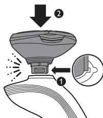
**7** 將電鬍刀組的突耳插入電鬍刀頂端的凹槽 (1)，再將電鬍刀組往下壓 (2) 即可安裝到電鬍刀上 (會聽見「喀噠」一聲)。
