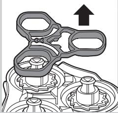
3 從電鬍刀刀頭固定座上取出固定架。
