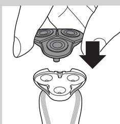
10 將電鬍刀刀頭固定座重新接上電鬍刀組的底部。
