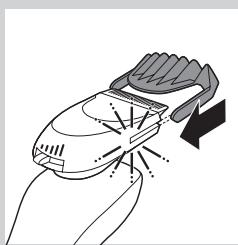
**1** 将修剪梳直接滑入胡须造型器附件两侧的导槽中（可听到“咔哒”一声）。
