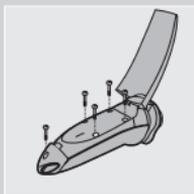
**1** 讓電鬚刀持續運轉直到完全停止為止，拆下螺絲並拆開電鬚刀本體。
