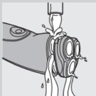
**3** 在熱水龍頭下沖洗電鬚刀組及鬚渣室，讓熱水沖洗電鬚刀組下方的開口至少 30 秒鐘。
