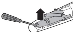
6 電池タグを切り、プリント回路基板から、
