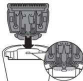
7 カチッと音がするまで刃を本体に押し込み、元の状態に戻します。
