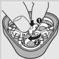
**5** Vratite granični okvir u jedinicu za brijanje (1) i okrenite točkić u smeru kazaljke na satu (2).
