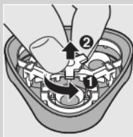
**2** Pritisnite gumb za otpuštanje (1) i izvadite jedinicu za brijanje (2).
