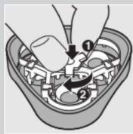
**7** Vložte holící hlavy zpět do holící jednotky. Umístěte přídržný rámeček zpět do holící jednotky (1) a otočte kolečkem ve směru hodinových ručiček (2).
