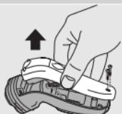
**2** Lăsați aparatul să funcționeze până când se oprește, desfaceți șuruburile și deschideți-l.
