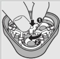
**4 Wyjmij nożyki i osłonki za pomocą dołączonej do zestawu szczoteczki.**
