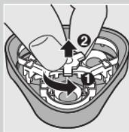
**2** Нажмите кнопку отсоединения бритвенного блока (1) и снимите бритвенный блок (2).
