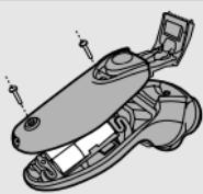
**2** Deixe a máquina a trabalhar até parar, abra o aparador, desaperte os parafusos e abra a máquina.
