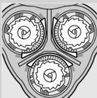
**3** Rode o anel para a esquerda (1) e retire a armação de retenção (2).
