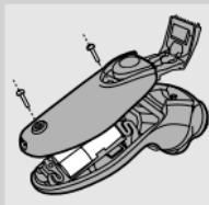
**2** Laat het apparaat lopen tot het stopt, klap de tondeuse uit, draai de schroeven los en maak het apparaat open.
