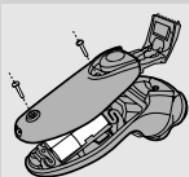
**2** Laissez l'appareil fonctionner jusqu'à l'arrêt complet, ouvrez la tondeuse, défaites les vis et ouvrez l'appareil.
