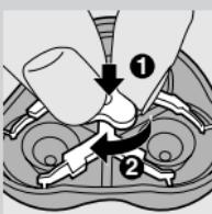
**4** Retire as cabeças e coloque cabeças novas na unidade de corte de modo que as partes com os orifícios pequenos fiquem viradas para o centro da unidade de corte.
