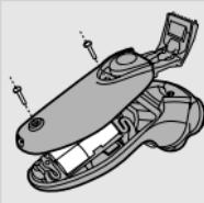
**2** Lassen Sie den Motor laufen bis er anhält, öffnen Sie den Langhaarschneider, lösen Sie die Schrauben und öffnen Sie das Gerät.
