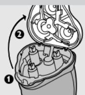
**1** Schakel het apparaat uit, haal de powerplug uit het stopcontact en trek het stekkertje uit het apparaat.
