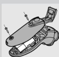
**2** Cihazı duruncaya kadar çalıştırın, vidaları söküün ve cihazı açın.
