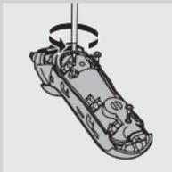
**5** Skruva ur de tre skruvarna ur den inkaplade strömenheten.
