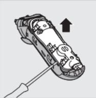
**6** Fjern bakpanelet på det forseglede drivverket med en skrutrekker.
