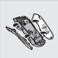
**3** Ξεβιδώστε τις δύο βίδες στο πίσω μέρος της ξυριστικής μηχανής και αφαιρέστε την πίσω πλευρά του περιβλήματος.
