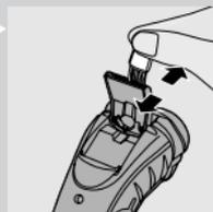
۳ هر شش ماه یکبار، دندان‌ه خط زن را با یک قطره روغن چرخ خیاطی روغن کاری کنید.
