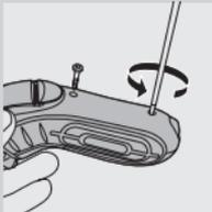
**2** Kör rakapparaten tills den stannar, skruva ur de två skruvarna i hårbehållaren och ta bort den.
