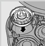
Die Vorsprünge an den Scherköpfen müssen genau in die Aussparungen der Schereinheit passen.
