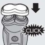
**1** 蓋上電鬍刀保護蓋以避免損壞。
