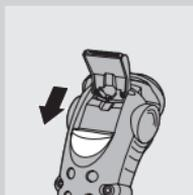
**1** Отворете ножчето за бакенбарди за подстригване чрез избутване на плъзгача надолу.
