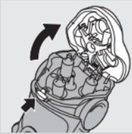
**1** Izslēdziet skuvekli, izvelciet barošanas kontaktdakšu no sienas kontaktligzdas, un izvelciet ierīces kontaktdakšu no skuvekļa.
