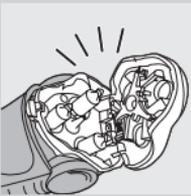
**5** Atkal atveriet skūšanas bloku un atstājiet to atvērtu, ļaujot ierīcei pilnīgi nožūt.
