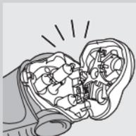
**5** Deschideți din nou unitatea de bărbierire și lăsați-o deschisă pentru a se usca complet.
