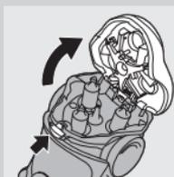
**1** Вимкніть бритву, вийміть вилку-адаптер з розетки електромережі, а вилку пристрою - з бритви.
