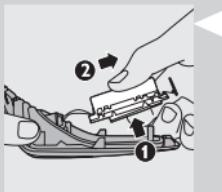
**7** Lösen Sie die drei Schrauben innen im Rasierer und nehmen Sie die Rückseite ab.
