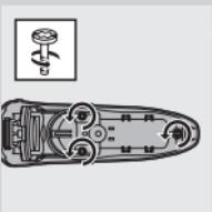
**7** Skru opp de tre skruene på innsiden av barbermaskinen og fjern baksidedekselet.
