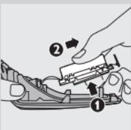
**8** Trekk ledningene ut av motorenheten og fjern batteriet.
