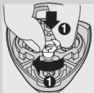
**5** Helyezze vissza a tartókeretet a borotvaegységbe, nyomja meg a tengelyt (1), és fordítsa el az óramutató járásával megegyező irányba (2).
