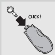
**3** Čerpadlo nasadíte na nový zásobník, až zřetelně zaklapne.
