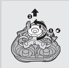
**4** Ruotate il sistema di bloccaggio in senso antiorario (1) e rimuovete la struttura di supporto (2).
