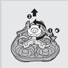
**4** Faites tourner le système de fixation dans le sens inverse des aiguilles d'une montre (1), puis retirez-le (2).
