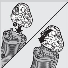
**8** Plaats het nokje van de scheerunit in de gleuf aan de bovenkant van het scheerapparaat (1). Sluit vervolgens de scheerunit (2).
