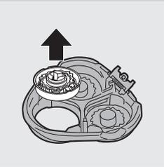
*Opmerking: Maak niet meer dan één mesje en kapje tegelijk schoon, omdat deze op elkaar zijn ingeslepen. Wanneer u de mesjes en kapjes per ongeluk verwisselt, kan het een aantal weken duren voordat het apparaat weer optimaal scheert.*
