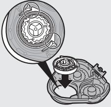
*Hinweis: Die Vorsprünge an den Scherköpfen müssen genau in die Aussparungen der Schereinheit passen.*
