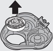
**5** Ta av og rengjør ett skjærehode av gangen. Hvert skjærehode består av en kniv og en lamelltopp.
