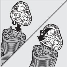
**8** Introduza a saliência da unidade de corte na parte superior da máquina de barbear (1). Em seguida, feche a unidade de barbear (2).
