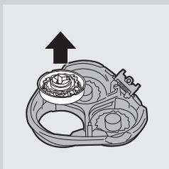
**5** Retire y limpie los cabezales de afeitado de uno en uno. Cada cabezal de afeitado consta de una cuchilla y su protector.
