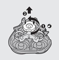
**4** Drehen Sie die Verriegelung gegen den Uhrzeigersinn (1), und entnehmen Sie den Scherkopfhalter (2).
