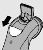
**1 Odprite rezilo s potiskom drsnika navzdol.**
