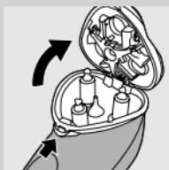
**1** Isključite aparat, izvadite adapter za napajanje iz zidne utičnice, a utikač iz aparata.
