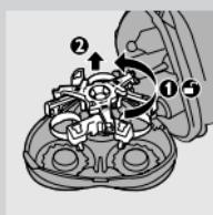
**4** Извлеките бритвенные головки из бритвенного блока и установите новые. Установите крепёжную рамку в бритвенный блок и поверните фиксатор по часовой стрелке.
